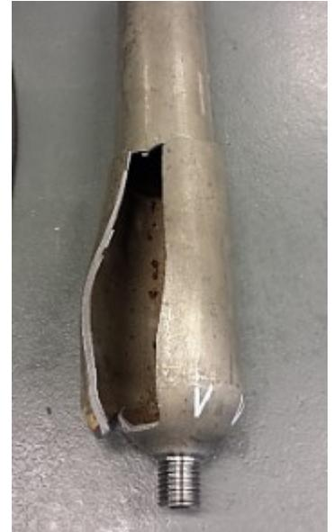
Berstprüfung an Sichtglas in einer von baromax eigens entwickelten Vorrichtung
